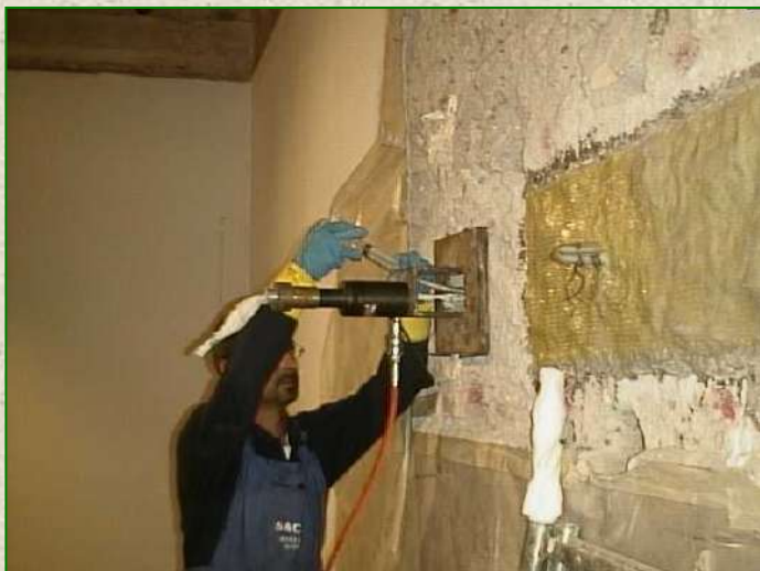
Esecuzione di campionatura con impiego di materiali compositi presso Villa Medici (Accademia di Francia) in Roma (Anno 2004)
